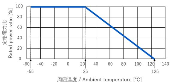
周囲温度が 25°C を超える場合は、上図の軽減曲線に従って定格電力を軽減して下さい。
